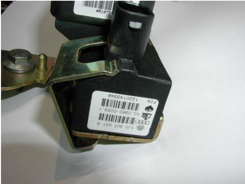
Bild 10: ESP Sensor 1J0907651A
