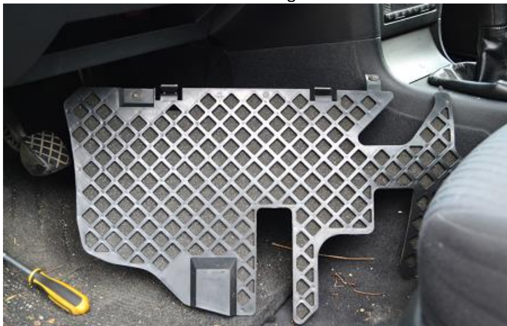
Bild 1: Die untere Fußraumabdeckung abbauen 2 Schrauben
