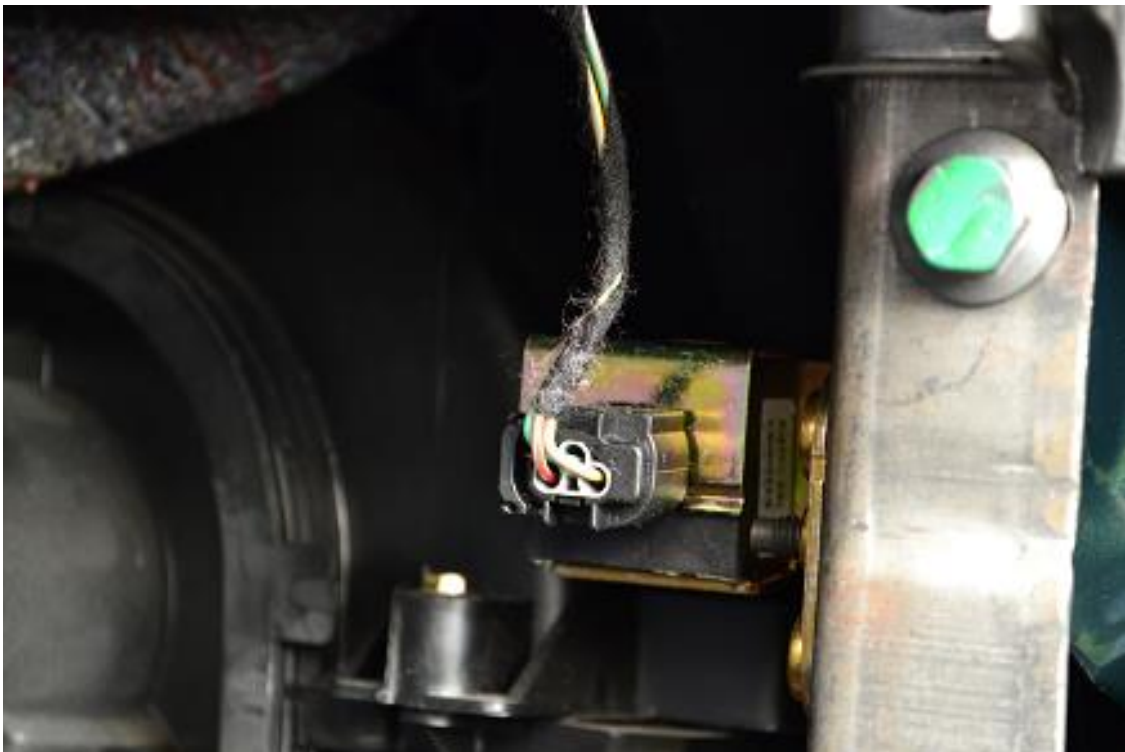
Bild 5 Der Sensor befindet sich rechts am Türholm. Der Stecker ist mit einer Einrastung gesichert. Durch Druck auf den Einrasthebel kann man den Stecker leicht abziehen. Der Sensor wird durch eine Klammer gehalten. Die Klammer mit einem flachen Schraubendreher aufhebeln.
