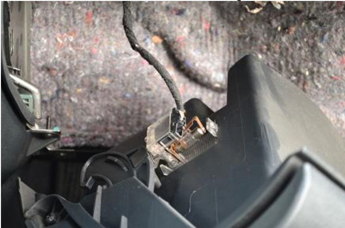
Bild 4 Stecker abziehen und Handschuhfach wegnehmen
