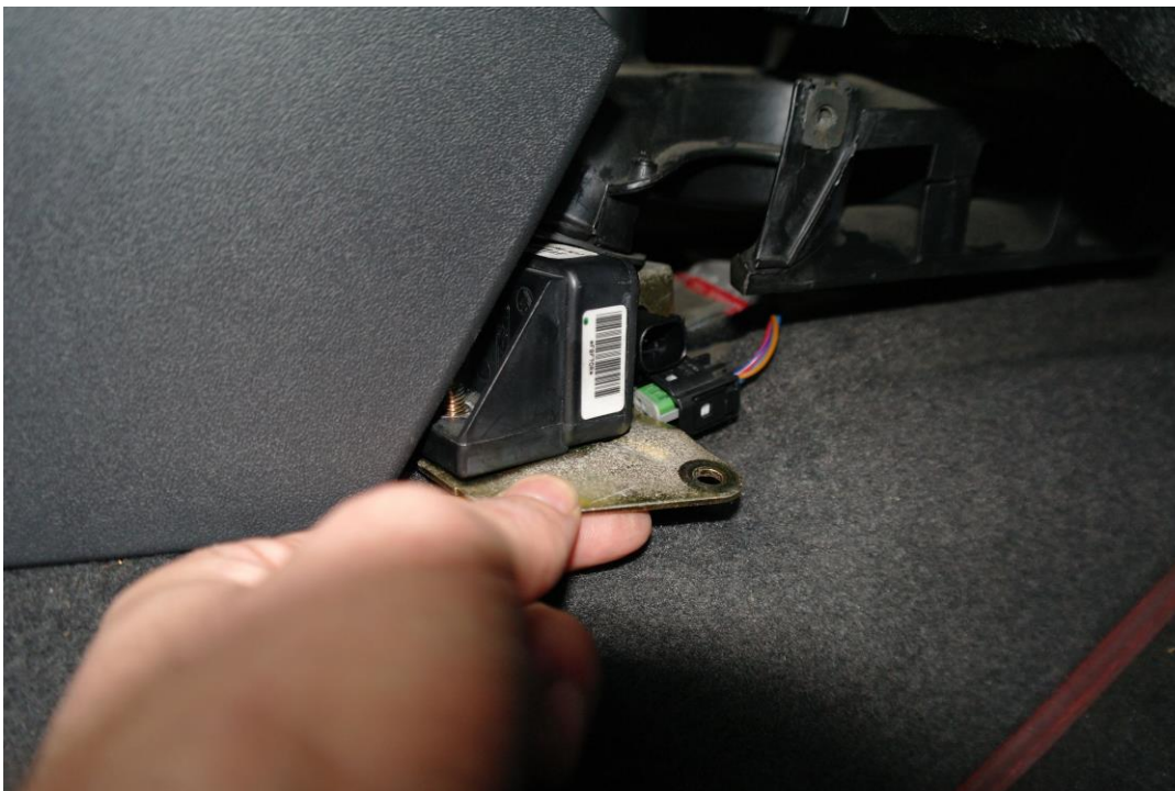
Bild 16: 2 Stecker abziehen, die Stecker sind codiert (keine Verwechslungsgefahr), den Messingträger mit den beiden Sensoren rausziehen.
