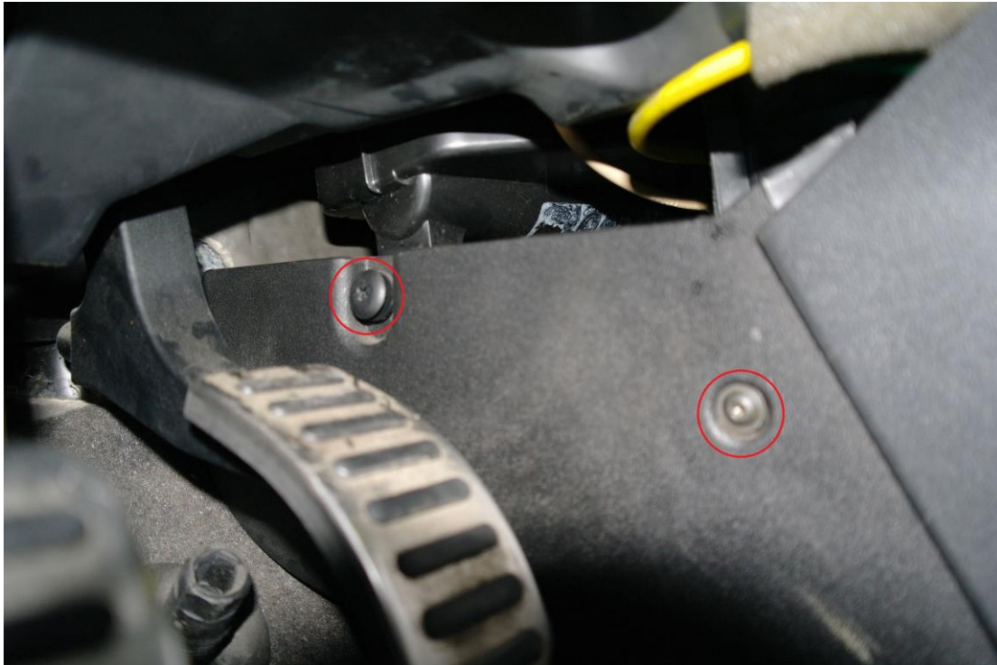
Bild 11: Torx Schrauben am Tunnel neben Gaspedal entfernen
