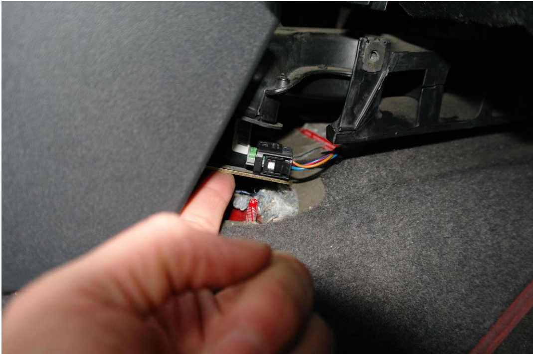
Bild 15: Auf dem Sensorträgerblech sitzen die beiden ESP Sensoren
