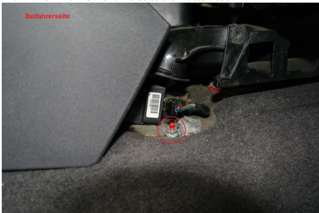
Bild 14: Beim Tunnel Beifahrerseite die Mutter lösen
