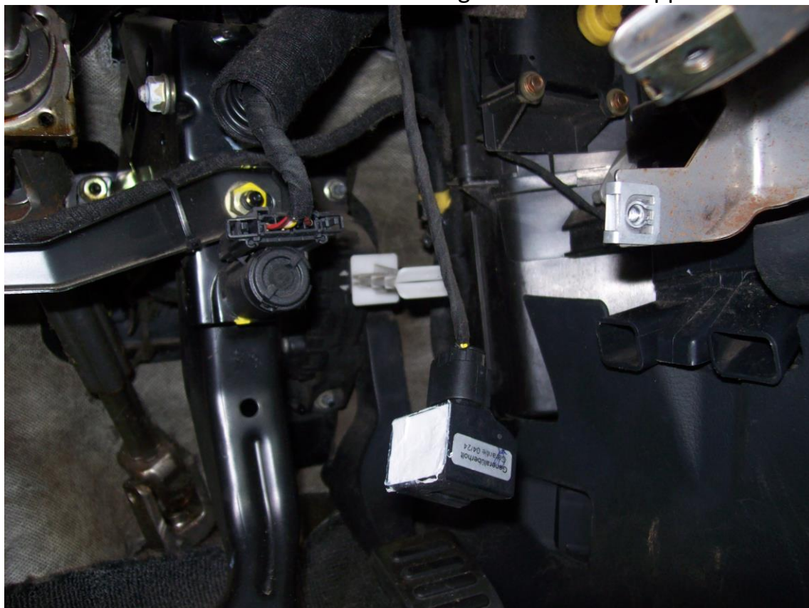
Bild 18: Beim Einbau die untere Abdeckung in die weißen Klipps schieben
