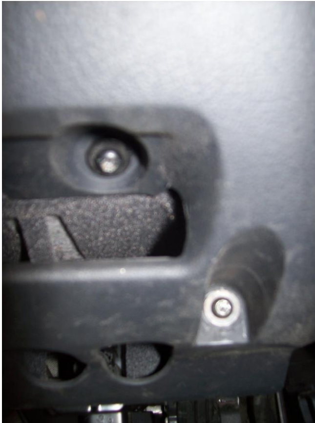
Bild 2 und 3: Untere Abdeckung abbauen, Schrauben entfernen
