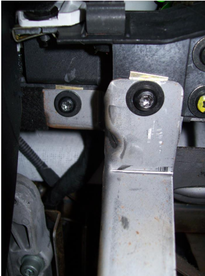
Bild 9 und 10: Schraube von Träger lösen
